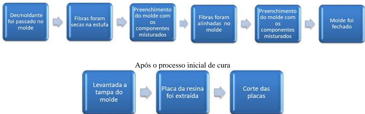
Figura 2: Fluxograma de fabricação dos corpos de prova
